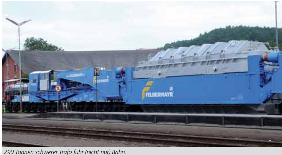
290 Tonnen schwerer Trafo fuhr (nicht nur) Bahn.
