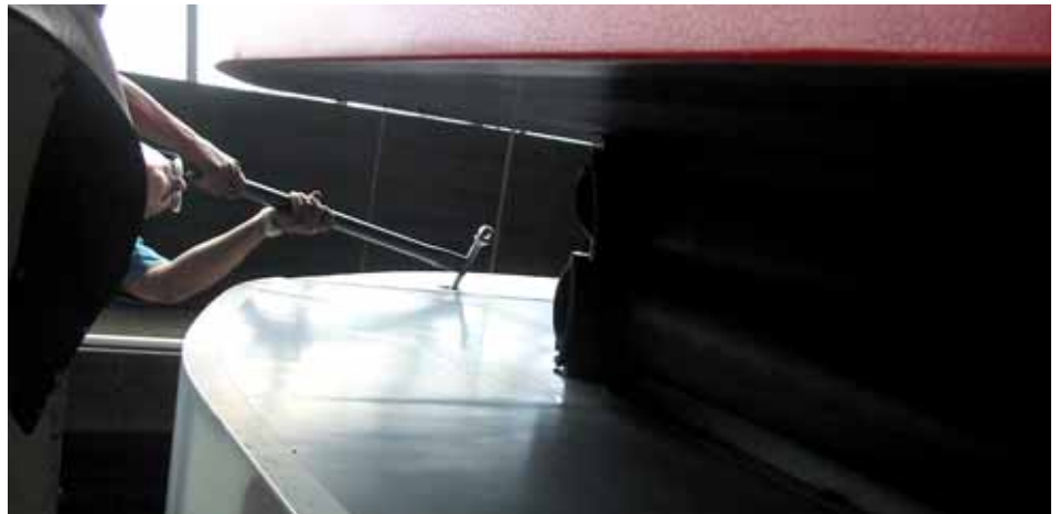
Idee 1314: Mit einem Ratschenringschlüssel können MitarbeiterInnen jetzt sicher und ohne körperlichen Aufwand die Verschraubungen der Dachelemente von Doppelstockwagen überprüfen.
